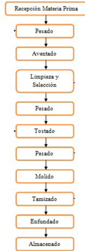
Figura 1. Diagrama de bloques del proceso
